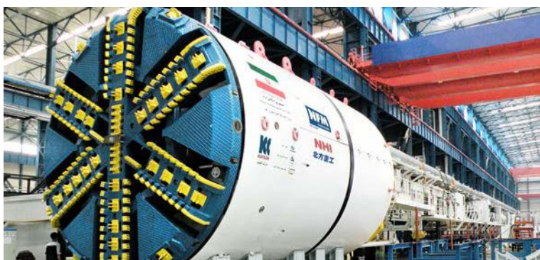
مشروع القطار المدني اهواز - جهاز تی بی ام TBM
