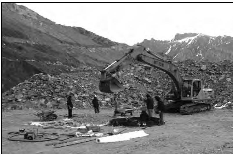
شکل ۶- نمایی از آزمایش دانسیته برجا
